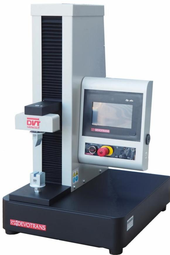
PERMET D'EFFECTUER DES ESSAIS DE TRACTION,
